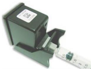
[utilizzando l'accessorio per la ricarica refill clip. Inserire la testina di stampa ricaricata sopra alla clip come da foto 1, uno scatto ne confermerà il corretto inserimento. Introdurre una siringa senza ago nel foro di gomma grigio sottostante e, tenendola verticale, aspirare 1 ml di inchiostro. **MPORTANTE:** lo stantuffo della siringa non deve mai tornare indietro. Estrarre quindi la siringa con lo stantuffo ancora tirato
