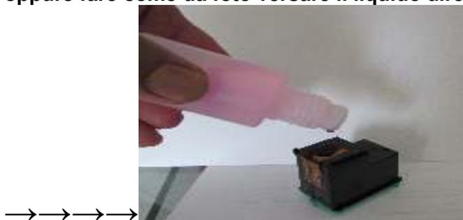
**Prima di reinserire la cartuccia nella stampante, asciugatela accuratamente. Il tempo necessario alla pulizia degli ugelli va da pochi minuti ad alcune ore a seconda del grado di intasamento e/o essiccazione dell'inchiostro.**
