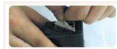
» Rimozione dell'etichetta adesiva della cartuccia
